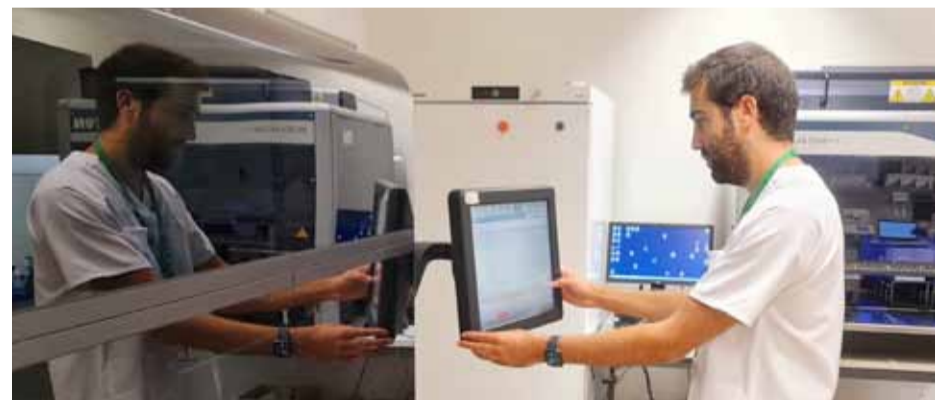
Equipo de diagnóstico molecular Panther (Hologic) que permite realizar múltiples pruebas para enfermedades infecciosas, salud de la mujer y virología.
