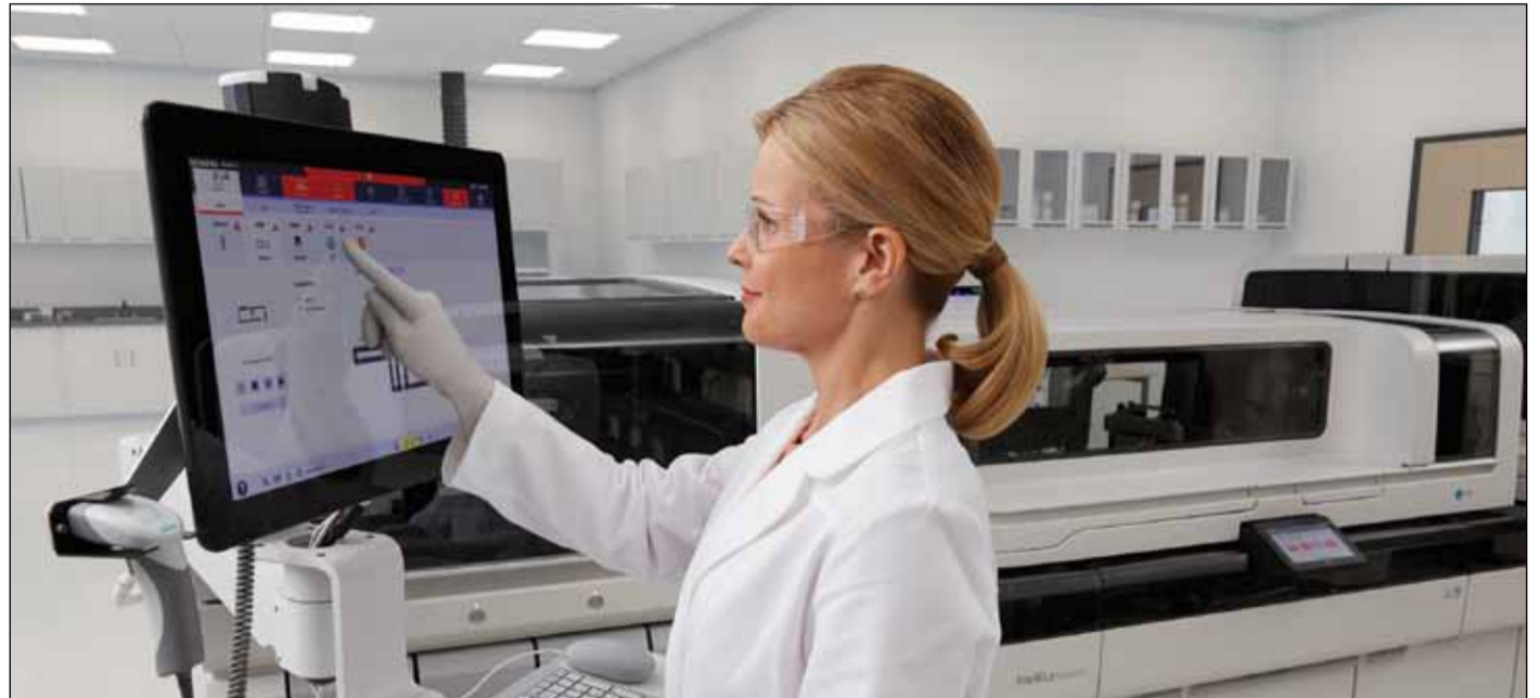
El analizador de inmunoensayo y bioquímica Atellica Solution incorpora IA en sus sistemas de visión multicámara para identificar y caracterizar instantáneamente cada tubo basado en los datos aprendidos.
